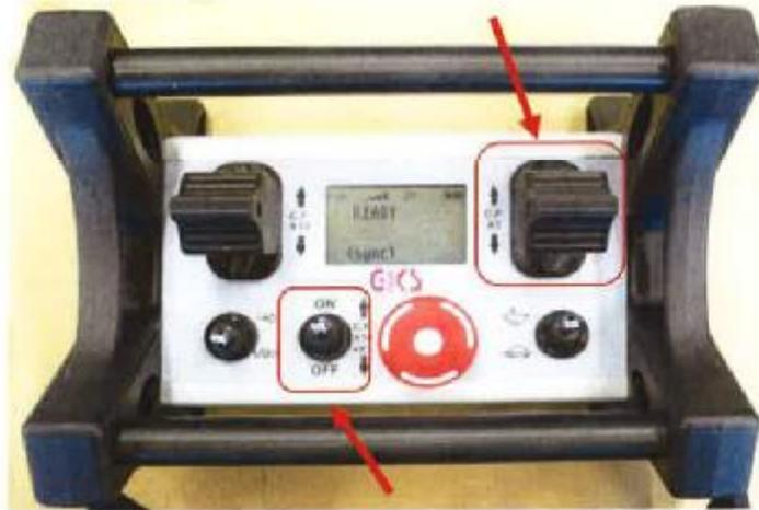
Un commutateur à bascule permet de passer de la direction manuelle à la conduite en ligne droite précise. Un levier à bascule permet ensuite de conduire en marche avant ou en marche arrière. Une indication correspondante apparaît sur l'écran.
