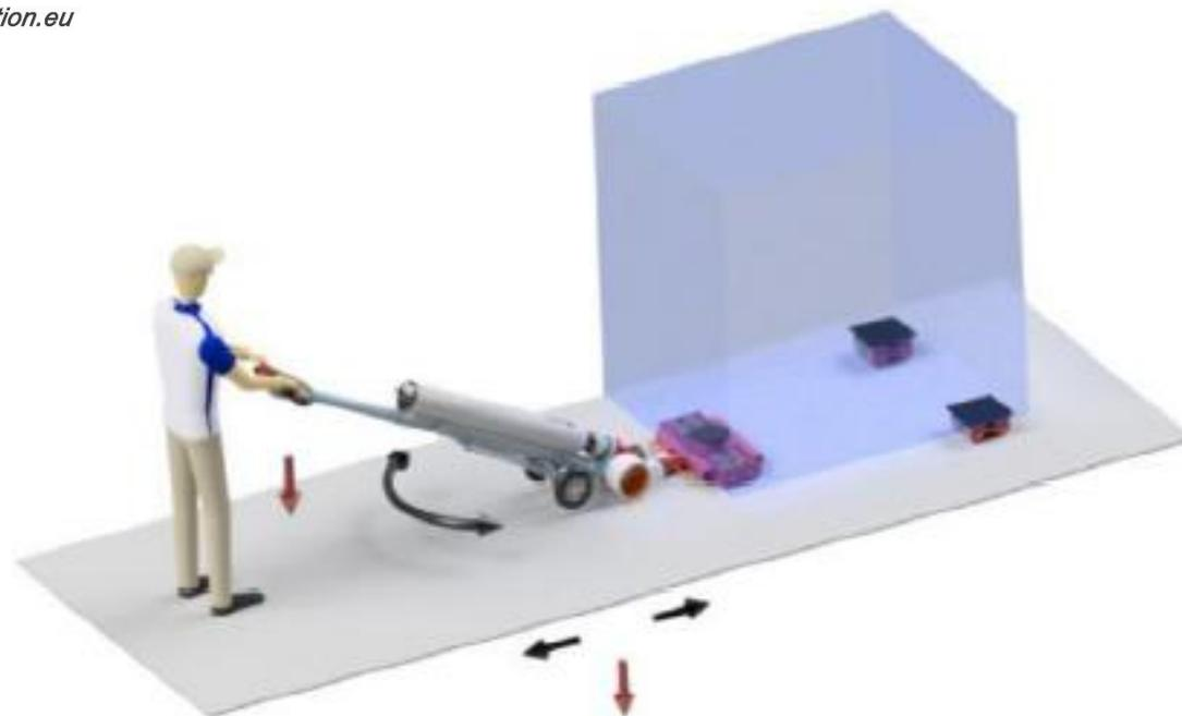
Le PowerAttack fonctionne sur le principe du « bras de levier » et de la traction. Lorsque l'opérateur appuie sur la poignée cela produit une force et presse les roues au sol de façon à générer la traction ou la propulsion. Les sols doivent être plans et propres : Les poussières, les graisses et l'eau gêne l'adhérence des roues au sol. Le nettoyage s'effectue avec un chiffon humide.
